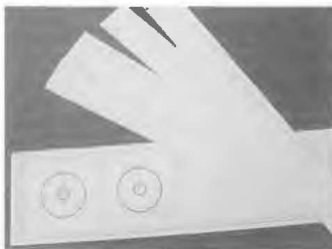
工作用紙を5cmの幅に4枚切る 凹レンズを取り付ける接眼部を切り取る
